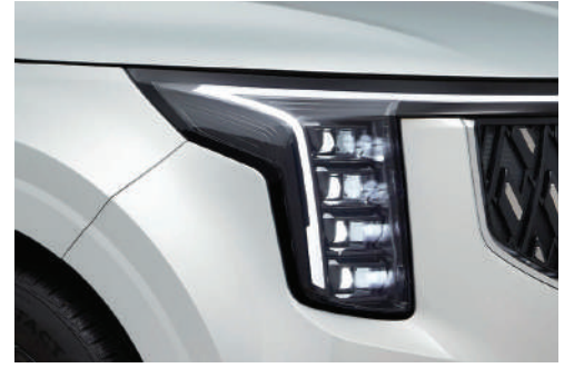
مصباح امامية LED بعدسة رباعية الازضاء LED 4-Cube Projection Headlamps
