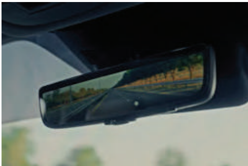
مرآة داخلية رقمية مع كاميرا Digital Central Mirror with Camera
