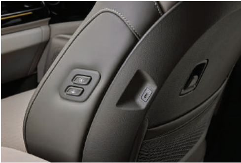
آلية تعديل المقعد الأمامي من الخلف Front Seat Adjustment Walk-In Device (Rear)
